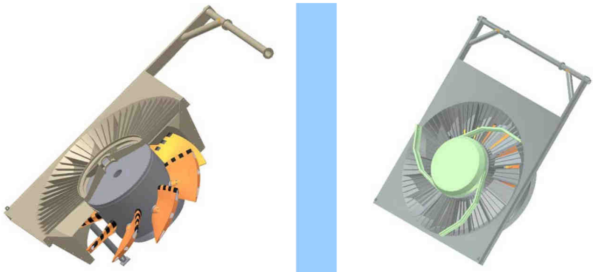
Fig. 29: Schnittbild und Ansicht (mit rotierendem Rechenreiniger) der VLH Turbine (Quelle: Stellba Hydro)
